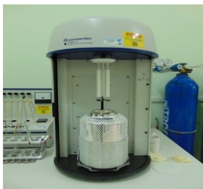
Hình 2.8. Thiết bị phân tích diện tích bề mặt và lỗ xốp TriStar II – Micromeritics (Mỹ)
