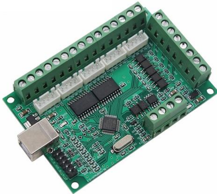
Hình 10. Mạch điều khiển CNC BOB MACH3 V2
