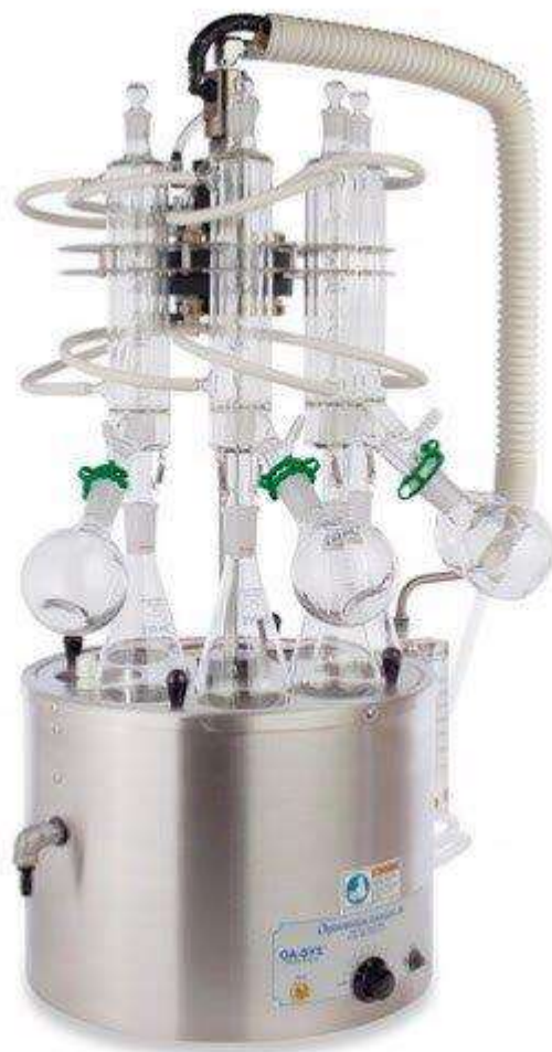
Hình 4 . Thiết bị chưng cất dung môi
