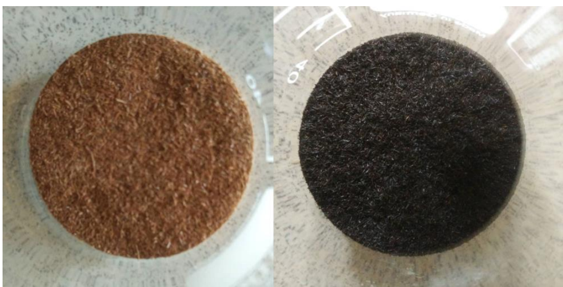
Hình 3.4. Hình ảnh lá thông trước và sau khi nung ở 310°C
