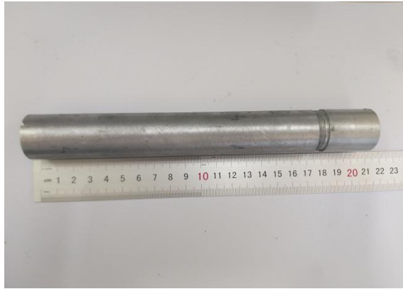
Hình I.3. Container nhôm dùng trong chiếu mẫu
